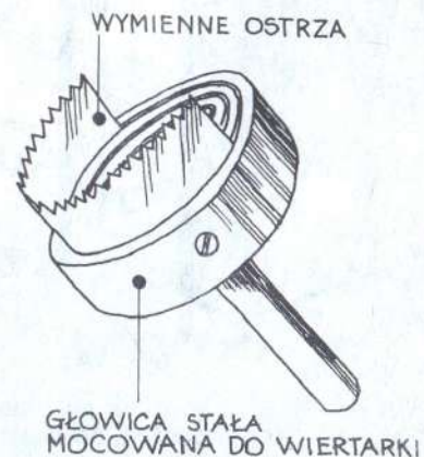
85. Urządzenie do wycinania otworów jako osprzęt do wiertarki (wierćło pikowe)
