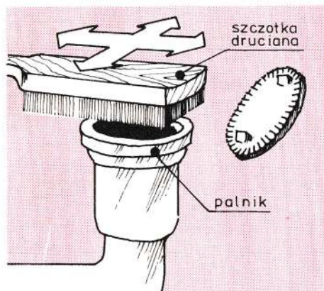
68. Czyszczenie palnika gazowego szczotką drucianą
